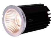
1 × 500mA LED Modul 9W – 2700K, 3000K oder 4000K Abstrahlwinkel 40° oder 60°
