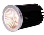
1 × 310mA DTW LED Modul 13W – 1800–3000K Abstrahlwinkel 40° oder 60°
