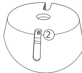
③ Haltekraft des Reflektors kann mit dem kleinen Inbusschlüssel eingestellt werden.
